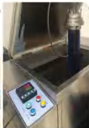
高温压力试验 High temperature pressure test
